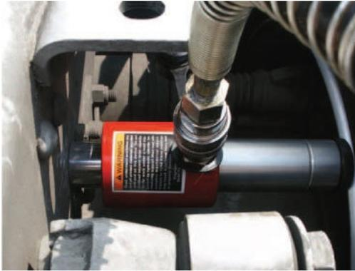
▲ Presse LKW-Rad vom Schiff aus mit der Mini-Press. Passt zwischen Fahrgestell und Rad.
