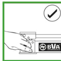
Auslassventil fingerfest schließen. Durch Gewaltanwendung wird das Ventil beschädigt.
