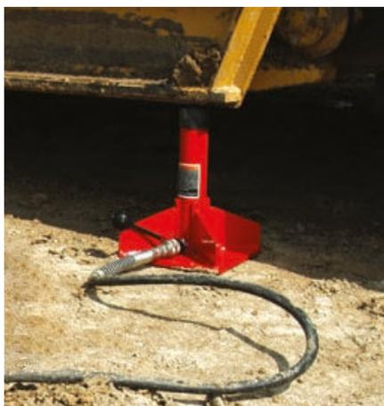
Einfachwirkender Zylinder H1506 eingefahrene Position mit CB15-Zylinderboden zur Sicherheit.
