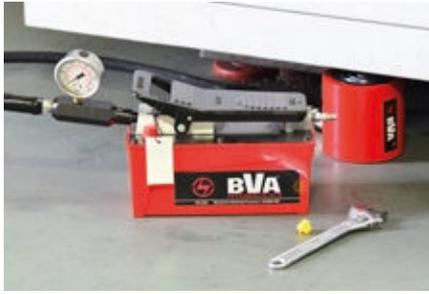
Hier sehen wir, wie unser Kombi-Satz SA15-3002L zum Heben einer Last eingerichtet wird. Dieser Kombi-Satz enthält einen HL3002-Zylinder, eine PA1500-Luftpumpe, einen CS3814-Schlauch, einen CH38M-Kupplungssatz, einen CF3814-Manometeradapter und ein GBW1460-Manometer.
