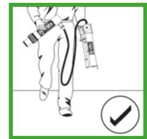
Heben Sie Hydraulikgeräte nicht an den Schläuchen an.
