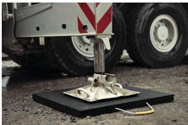
Bei den Stützpolstern handelt es sich um Auslegerpolster für Mobilkräne, LKW-montierte Kräne, Hubarbeitsbühnen, Betonpumpen, Container, hydraulische Heber usw.
