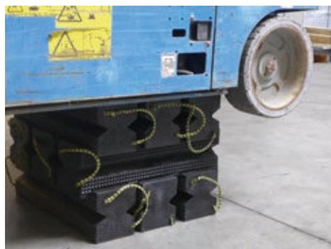
▲ Die Stabilisierungsblöcke sind nach einem System von ineinandergreifenden Blöcken konzipiert. Auf diesem Foto sehen wir SB 002B-Blöcke, die für eine 3-stufige Unterbauanwendung eingerichtet sind.
