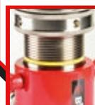
BVA Flachzylinder mit Sicherungsmutter sind mit einem gelben Sicherheitsband ausgestattet. Kolben nicht über diesen Punkt hinaus ausfahren, da dies zu einem Verlust von Hydrauliköl und zu Schäden am Zylinder und/oder der Last führen kann.
