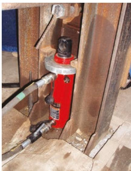
▲ HD-Zylinder können in Schub- und Zugsanwendungen eingesetzt werden. Auf diesem Foto sehen wir einen HD-Zylinder HD2506, der mit einem Zylinderzubehör in Form eines Kolbengabelkopfs für eine Zugsanwendung eingerichtet ist
