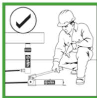
Verwenden Sie keinen Griffverlängerer. Handpumpen sollten bei richtiger Anwendung leicht zu bedienen sein.
